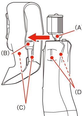
1 砥石取付軸 (A) を包丁研ぎ用カバーの溝 (B) にしっかりと差し込みます。
