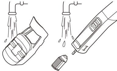
包丁研ぎ用カバーなど、砥石取付軸にたまつた汚れは、定期的に水またはぬるま湯でよく洗い落としてください。汚れが落ちない場合は、柔らかい布やスポンジを使用します。洗い落とした後は、乾いた布などで水気をよく拭き取ってください。
